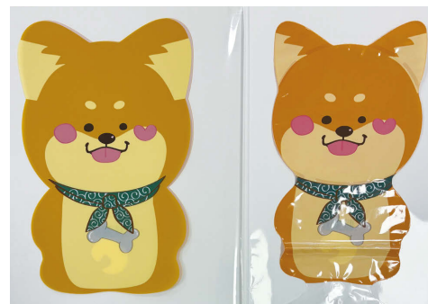
(左) インクジェット校正 (右) グラビア印刷
