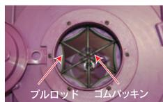
キャップを開けカムを回し、ブルロッドの先端を中央部の位置にして下さい。
