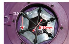
ブルロッドに付いているゴムパッキンを全て写真と同じ位置までスライドして下さい。これで、インサートパッキンの取付け完了になります。
