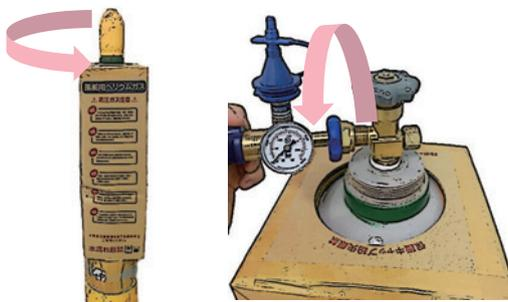
ヘリウムガスボンベへの器具の取り付け方動画
