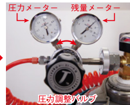
元栓をゆるめ、圧力調整バルブでガスが出る量を調整します。
