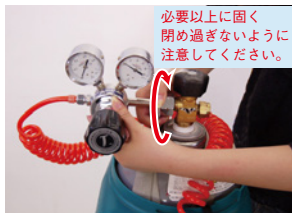
必要以上に固く閉め過ぎないように注意してください。 矢印の方向へ回し、しっかりと手で閉め込んで下さい。 ※板レンチを使用しなくてもしっかりと閉まります。
